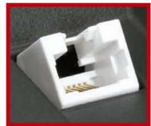
La CS3 lleva en su parte inferior un conector directo para los actuales S88.
